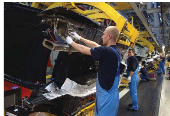
Schwenkmontage mit Werkermitfahrerband
