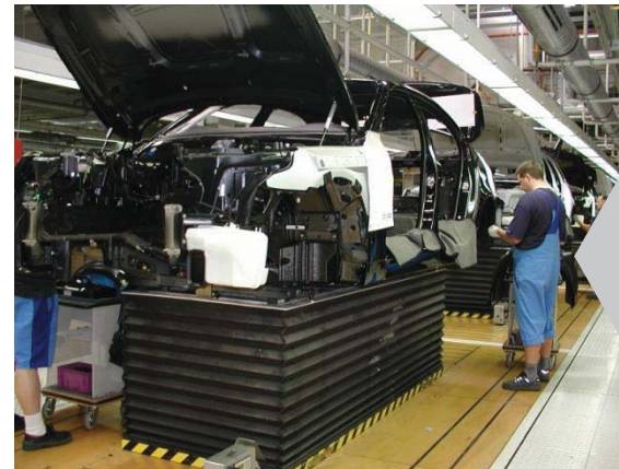
Schwenkmontage mit Werkermitfahrerband
